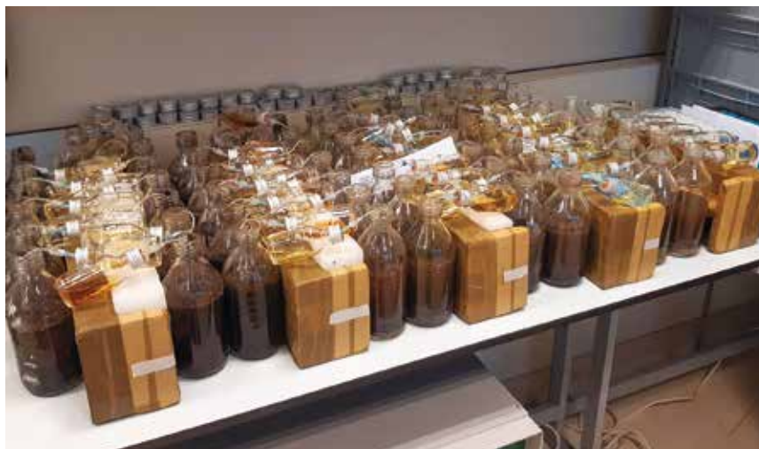
Figuur 2 Opzet van de labproef: monsterflessen nadat ze op de schudmachine hebben gestaan.
