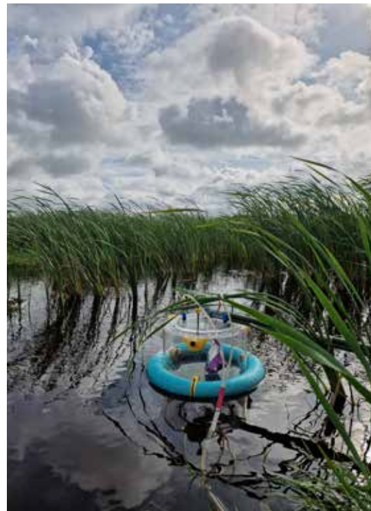
Figuur 1 Onderzoek naar de productie van lisdodde op een vernatte veenbodem. Op de voorgrond is een drijvende kamer geplaatst waarmee broeikasgasemissies gemeten worden. Foto: Stefan Weideveld.
