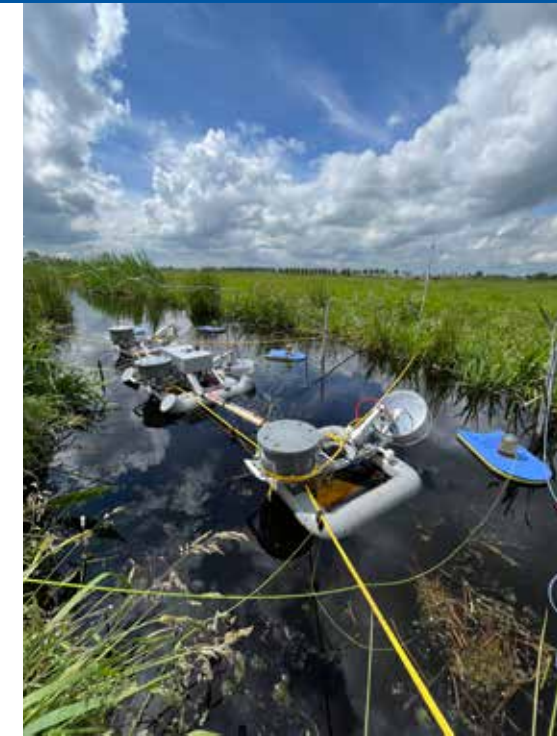
Figuur 2 Moderne drijvende automatische meetsystemen die met hoge frequentie broeikasgasemissies uit het oppervlaktewater kunnen meten. Aan de blauwe drijvers zijn ebullitievallen opgehangen waarin bellen met broeikasgassen worden opgevangen. Foto: Judith van der Knaap.
